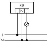
Commande d'éclairage en fonction du mouvement et de la luminosité
